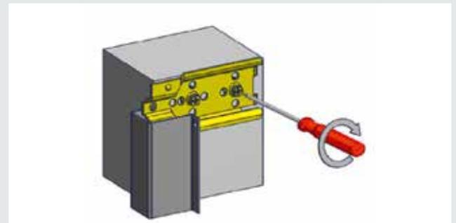
Der Nivellieranker mit Führungsanker ist besonders montagefreundlich. Mit einem Schraubendreher lässt sich der Abstand zur Wand einfach einstellen.
