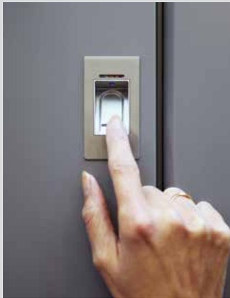
Aus dem eingescannten Bild Ihres Fingers werden spezielle Merkmale herausgefiltert, als biometrischer Schlüssel abgelegt und verglichen. Maßgeblich hierfür ist nicht das Muster des Fingerabdrucks, sondern die Temperaturunterschiede an spezifischen Punkten des Fingerabdrucks.
