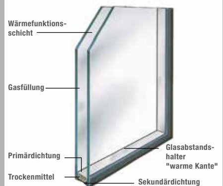
Wärmeschutzglas U g 1,1 mit 1 x Randverbund "warme Kante"
